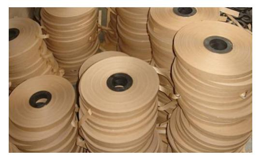
绝缘材料在生活中是不可或缺的 绝缘材料在电工产品中是必不可少的材料. 例如一台300MW汽轮发电机就需绝缘漆10t□云母制品8t□层压板5t□漆布和薄膜约1t;一台3200kW的变压器所需绝缘材料占其总质量的34%;一台10kV的高压断路器所需绝缘材料占其总量的18%. 按我国发电设备装机容量及与之配套的电工设备的绝缘材料消耗定额平均为65t/10MW,由此可见绝缘材料在电工设备中所占比例是很大的。电工常用的绝缘材料按其化学性质不同,可分为无机绝缘材料、有机绝缘材料和混合绝缘材料。常用的无机绝缘材料有:云母、石棉、大理石、瓷器、玻璃、硫黄等,主要用作电机、电器的绕组绝缘、开关的底板和绝缘子等。有机绝缘材料有:虫胶、树脂、橡胶、棉纱、纸、麻、人造丝等,大多用以制造绝缘漆,绕组导线的被覆绝缘物等。混合绝缘材料为由以上两种材料经过加工制成的各种成型绝缘材料,用作电器的底座、外壳等。
