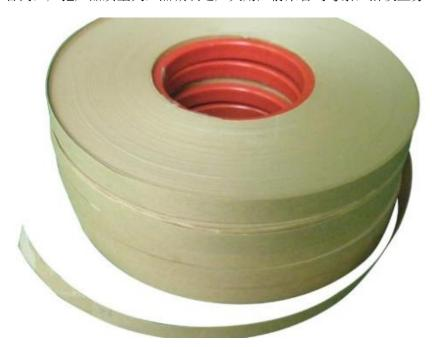
电缆纸是包在电缆\*\*外层,用以保护导电线芯的绝缘层密封,不使潮气侵入,也不让绝缘层遭受破坏。 为卷筒纸。定量为45□175g/m2□纸质坚韧、匀整。有较高的抗张、耐折和撕裂强度。不含金属、沙粒及能导 电的酸性物质。介电常数高。功率因数低。经受绝缘性液体处理时,纸的稳定性良好。其品种依据不同厚度或 颜色来划分。以未漂强酸盐针叶木浆为原料,经游离状打浆后,不施胶,不加填(料),在长网造纸机上抄造而 成。用于电线或电缆的匝间绝缘。
