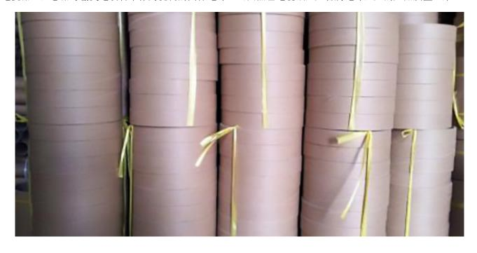
电缆纸是一种低电压等级绝缘纸,百度适用于制造35KV以下的变压器使用的电磁线以及电力电缆或其它电器
