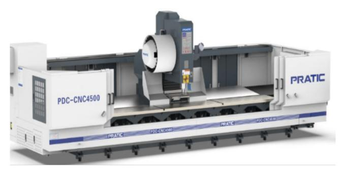
当我们谈论到了加工中心间之后,我们就能够更加明确的体会到智能化的要求。型材加工中心其实就是一种高度智能化的数控机床,相比普通的数控机床来说,它的质量和工作能力已经很大的提高。它能够在同一时间内进行不同工序的加工工作,而且还能够进行换刀的要求。在这种条件之下,工业生产的效率就随之很大提高。而普通的车床做是一种比较简单的工业生产工具,只能生产一些单位和批量比较小的零件,并且完全需要人工的操作来进行。但是数控机床能智能化就比较多了,它能够批量的生产所需要的一些零件,在整个程序得到完整的调制之后,就可以基本上完成自动加工。
